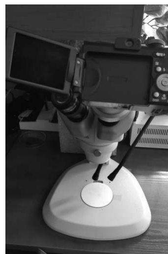
Fot. 7. Mikroskop stereoskopowy Nikon SMZ 645 (fot. D. Magiera)
